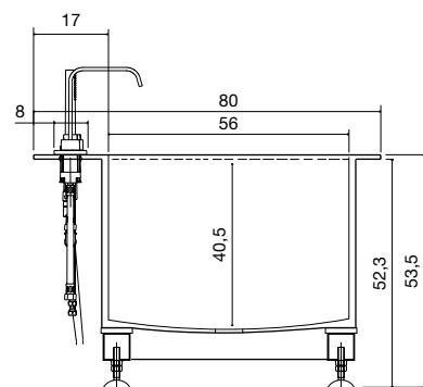
Tutti i modelli Art. BIBLIO sono corredati di un sistema di scarico illustrato di seguito, completo di troppopieno nascosto che funziona mediante l'utilizzo del principio dei vasi comunicanti (A), sifone (D), e piletta con scarico a pressione "clik-clak", che può svolgere anche la funzione di erogazione (B), da attivare solo in abbinamento ai rubinetti Art. ES702SA, Art. ES702LU, Art. ES702V e Art. ND702 o a qualsiasi rubinetto bordo vasca sprovvisto di bocca di erogazione.
