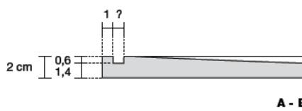
FRESATURA PER INSTALLAZIONE
