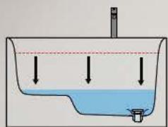
Sistema TROPPOPIENO AUTOMATICO INVISIBILE. La piletta si apre automaticamente al raggiungimento del livello di sicurezza PREDEFINITO, permettendo all'acqua di defluire.
